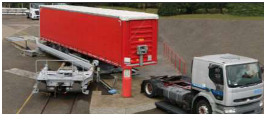
Der Sattelaufleger wird mit dem eigenen Zugfahrzeug oder einem Terminaltruck auf die ausgeschwenkte Tragwanne gezogen und diese zur Fahrt zurückpositioniert; Foto: LOHR Industrie.
